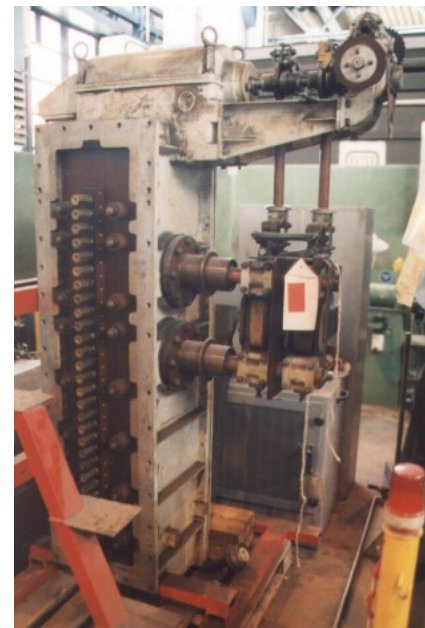
Stufenschaltwerk einer schweren Güterzuglok der Baureihe 150. Links sind die Anschlüsse für die 28 Trafo-Anzapfungen zu sehen, rechts (hinter dem Schild) die beiden Lastschalter.
